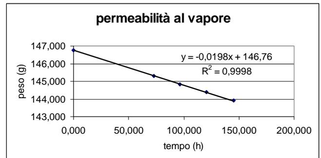
Considerando la resistenza del supporto ( $S_d = 0.0652$  m), si ricava, per il campione in esame, il seguente valore medio di resistenza al trasporto:
