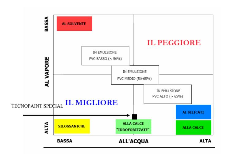
Il prodotto "TECNOPAINT SPECIAL" ha dimostrato eccellenti prestazioni di traspirabilità (alta permeabilità al vapor d'acqua), e media idrorepellenza (media permeabilità all'acqua liquida).
